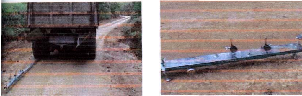
Fotografías 24 y 25. Medida de deflexiones Benkelman
