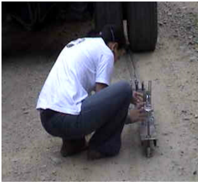
Fotografía 1. Se observa la Viga Benkelman, antes de registrar las deflexiones
