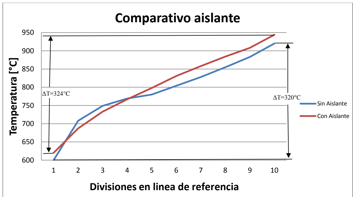
Figura 43. Temperatura en línea de referencia (aislante).
