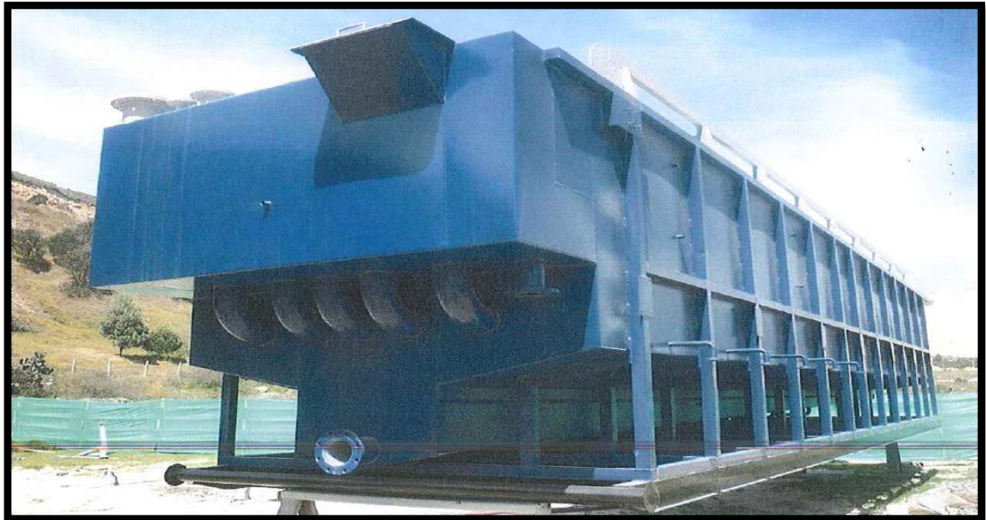
Figura 24. Aspecto exterior de un Separador de flotación por aire disuelto.
