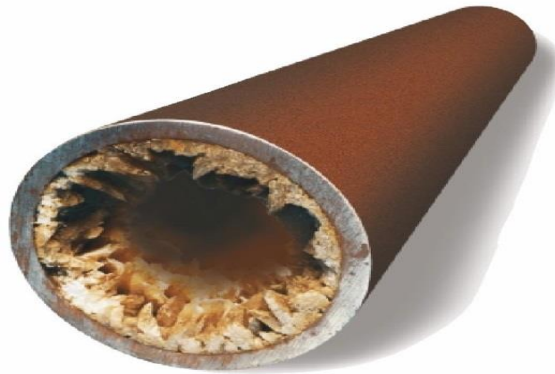
Figura 10. Incrustaciones en tubería petrolera
