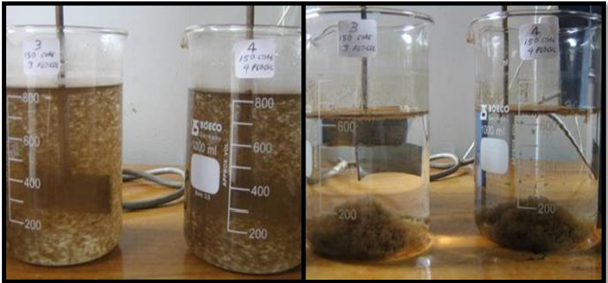
Figura 46. Efecto de coagulante y floculante sobre el agua contaminada
