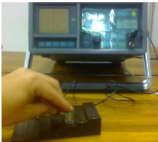
Figura 44. Detección de Falla con Escalerilla [Autores]
