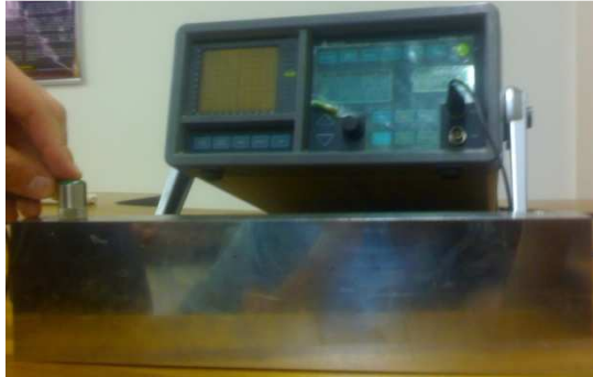
Figura 41. Detección de Falla en Placa de Acero [Autores]
