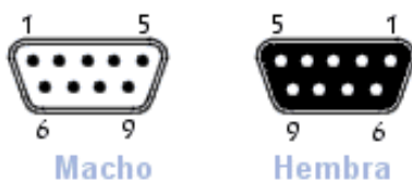
Figura 31. Conector DB9 macho y hembra [11]
