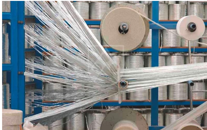
Figura 36. Alimentación en rollo para proceso de pultrusión.
