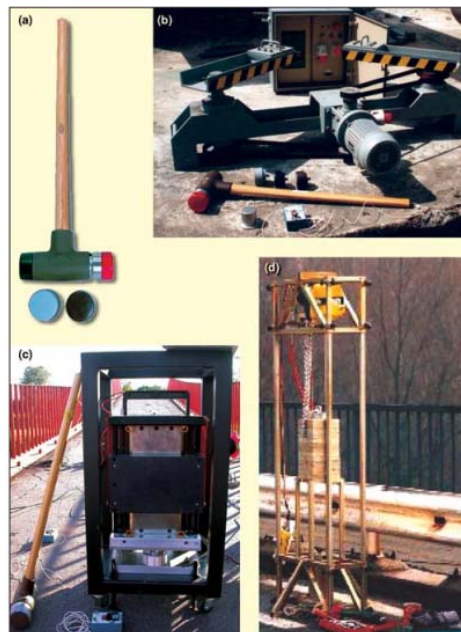
Figura 1.1 Herramientas de excitación usadas en el método input-output (a) Martillo de impulso; (b) vibrador de masa excéntrica; (c) Shaker electrodinámico sobre tres células de carga; (d) dispositivo de excitación.
