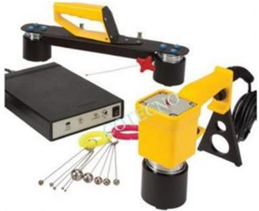
Figura 5. Dispositivo de ensayos eco impacto. Adaptado de <https://www.cotecno.cl/nuestros-productos/eco-impacto-sistema-de-ensayo-para-concreto-h-2851/>
