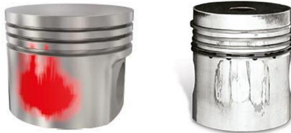
Figura 2. Contacto en seco en la falda del pistón
