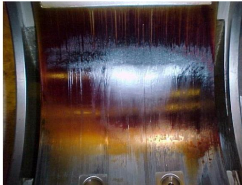
Figura 4. Presentación de barniz en un cojinete de turbina
