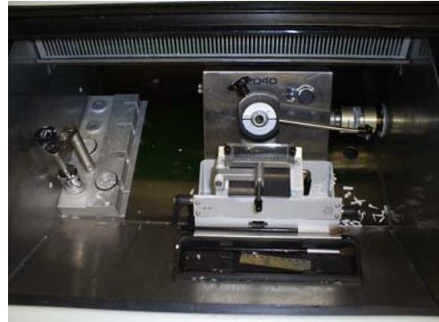
Cortador de Secciones para Análisis Histológicos (Cryo cut 1800, jung 1800, Hystotronic Inc. Leica, vista superior)
