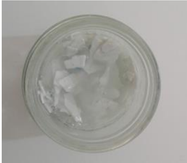
Figura 36. Prueba disolvente cloruro de metileno.
