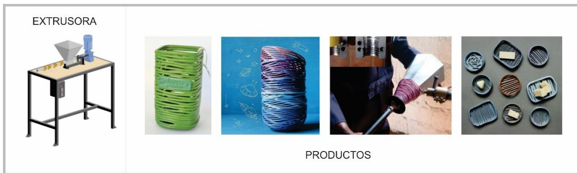
Figura 9. Máquina extrusora y productos obtenidos. Adaptado de Preciousplastic. (sf).
