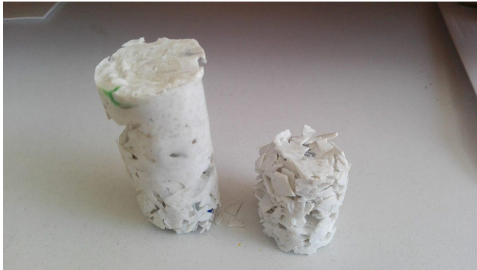
Figura 33. Probetas antes y después de la compresión
