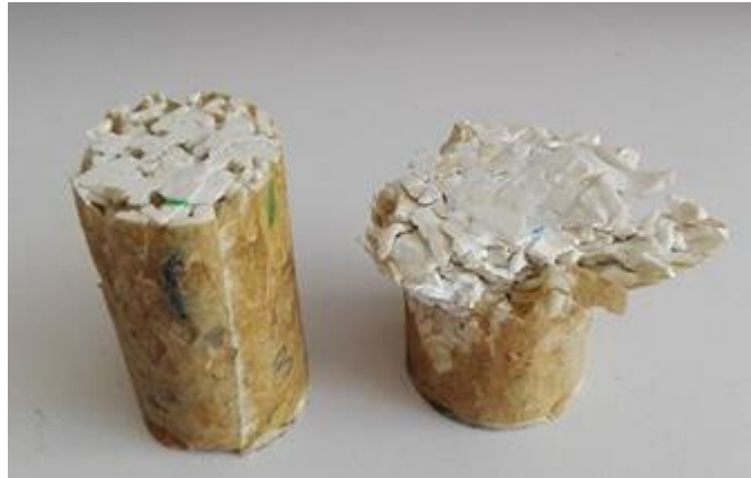
Figura 30. Probetas antes y después de la compresión
