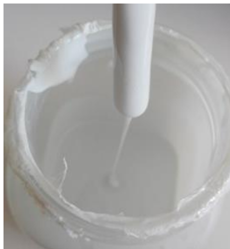
Figura 37. Poliestireno disuelto en cloruro de metileno
