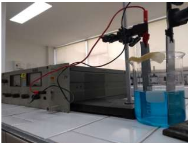
Figura 8. Montaje para la electrodeposición de cobre en licores de la primera lixiviación.
