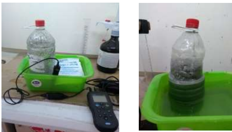
Figura 24. Ensayos preliminares de estabilidad en un contenedor plástico. A la derecha se puede observar cómo fue derretido el contenedor por el incremento de la temperatura.
