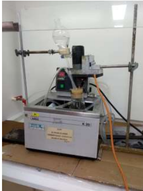
Figura 26. Montaje final elegido, en el cual se controla la temperatura del sistema por medio del baño termostatado para impedir el derrame de la solución.
