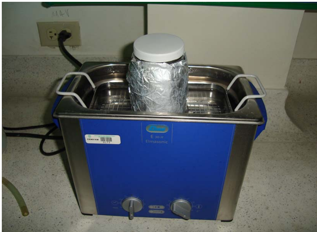
Figura 7. Equipo de ultrasonido (EMA, E30 H, Elmasonic) utilizado para extraer el concreto.
