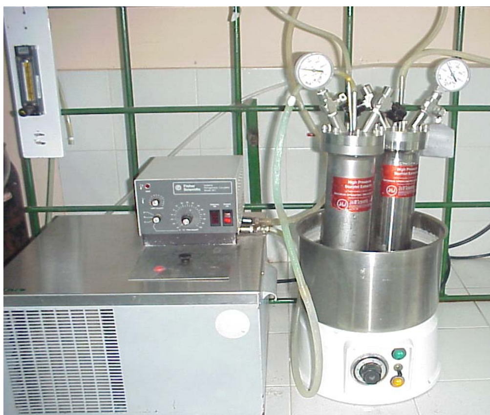
Figura 5. Equipo Soxhlet de alta presión (J & W Scientific) para la SFE con CO 2 .
