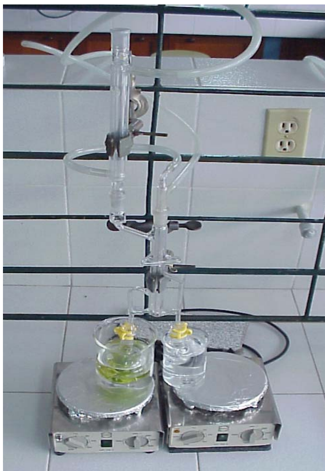
Figura 4. Montaje de destilación-extracción con solvente simultánea.
