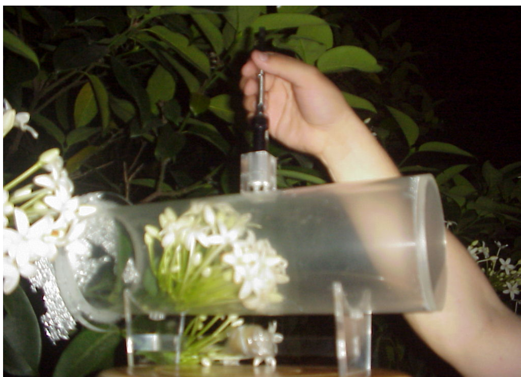
Figura 6. Montaje de microextracción en fase sólida en el modo headspace , HS-SPME. Muestreo in-vivo de los volátiles de flores.
