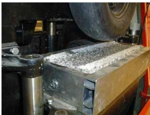
FIGURA 46 Acercamiento de la llanta y la placa en el ensayo de rodera francés
