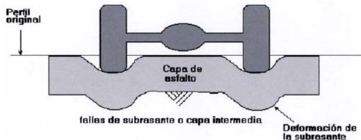
FIGURA 13 Roderas por fallas en la subrasante
