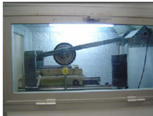
FIGURA 63 Maquina de pista NLT para realizar el ensayo de simulación
