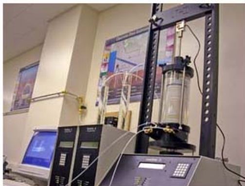
FIGURA 30 Sistema para el ensayo triaxial estático
