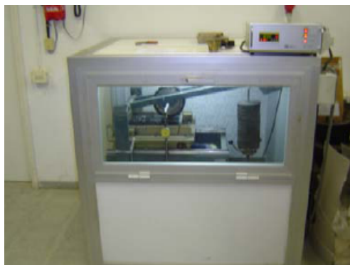
FIGURA 63 Maquina de pista NLT para realizar el ensayo de simulación
