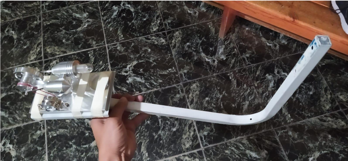
Figura 56: Instalación del motor al brazo finalizado
