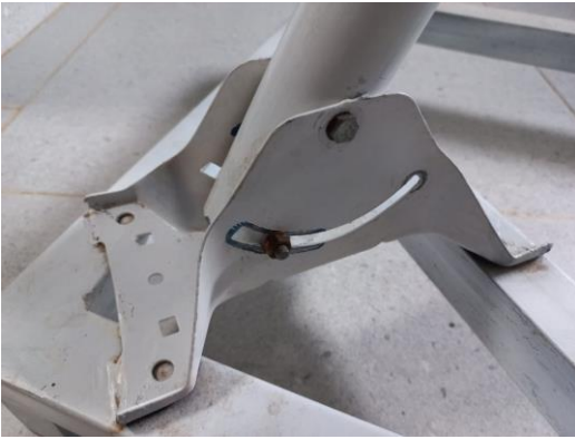
Figura 58: Articulación del concentrador solar
