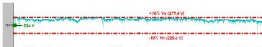
Gráfico 1: Detalle del comportamiento de la tensión fase – neutro en el transformador No. 1 de la subestación PP6
