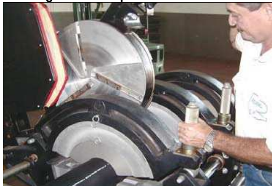
Figura 24. Limpieza de los extremos
