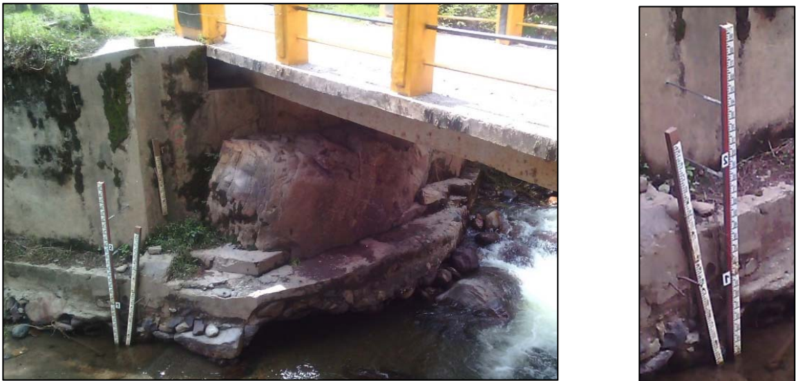
Imagen 1. Estación de monitoreo con mira limnimétrica en funcionamiento SA-07
