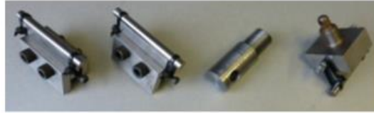
Figura 60. Narices de soportes de prueba de flexión de tres puntos, collar base y nariz de carga (de izquierda a derecha). Adaptado de Northmore. A. (sf). Canadian Solar Road Panel Design: A Structural and Environmental Analysis
