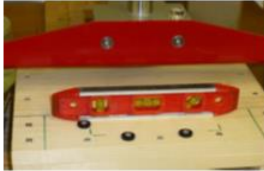
Figura 70. Plataforma de prueba de fricción. Adaptado de Northmore, A. (sf). Canadian Solar Road Panel Design: A Structural and Environmental Analysis
