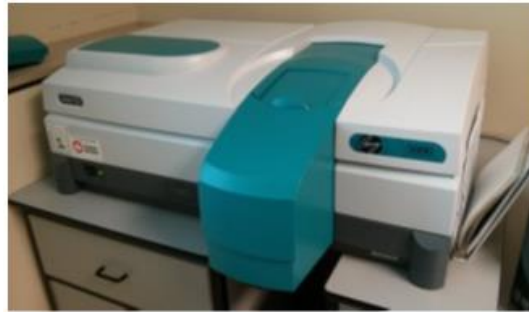
Figura 64. Espectrofotómetro Varian Cary 5000 UV / VIS / NIR. Adaptado de Northmore. A. (sf).
