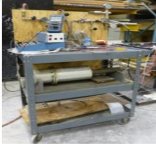
Figura 40. Sistema de aplicación de fuerza aire-aceite. Adaptado de Northmore, A. (sf). Canadian Solar Road Panel Design: A Structural and Environmental Analysis
