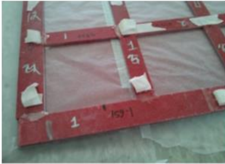
Figura 47. Capa óptica pegada con resina epóxica. Adaptado de Northmore. A. (sf). Canadian Solar Road Panel Design: A Structural and Environmental Analysis
