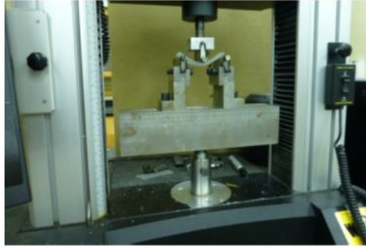
Figura 61 Prueba del material con la Instron adaptada para el ensayo. Adaptado de Northmore. A. (sf). Canadian Solar Road Panel Design: A Structural and Environmental Analysis
