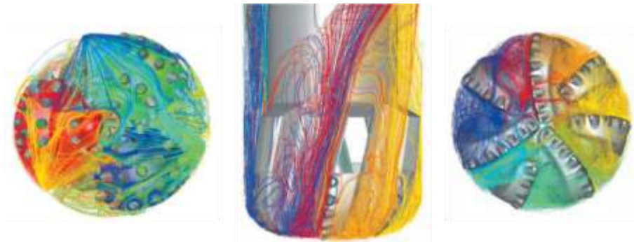
Figura 7. Análisis del flujo de un fluido de perforación en una broca tricónica y PDC..
