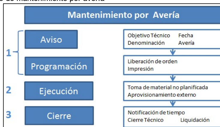
Figura 4. Proceso de mantenimiento por avería
