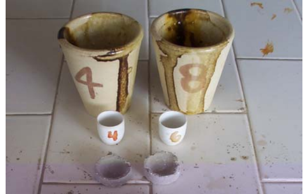
Figura 8. Mufla, crisoles y copelas requerido para el ensayo al fuego
