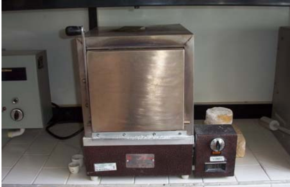
Figura 8. Mufla, crisoles y copelas requerido para el ensayo al fuego
