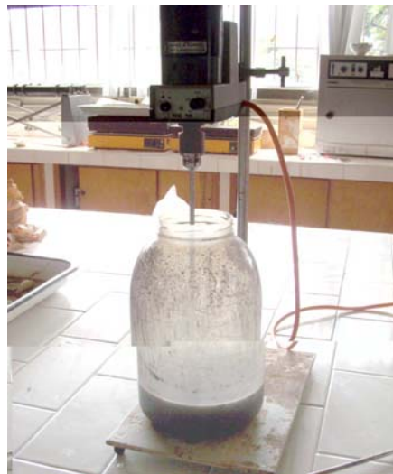
Figura 6. Esquema del montaje experimental de Lixiviación por agitación
