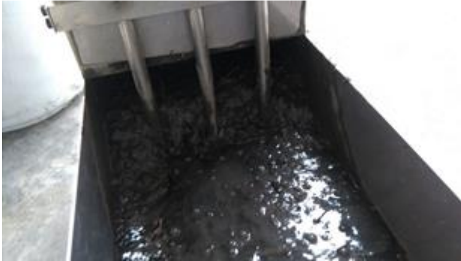
Figura 13. Obstrucción de fibras en L-Box. Fuente: Autores.
