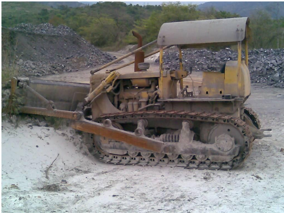
Figura 14. Bulldozer CAT D6C
