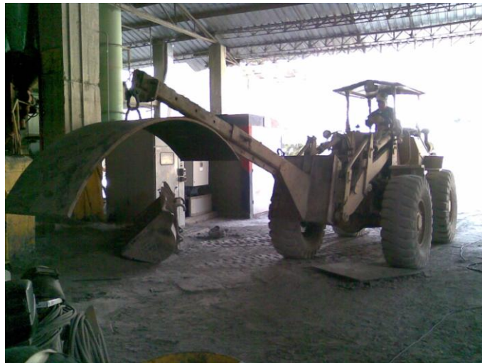
Figura 38. Cargador Transportando ruana metálica
