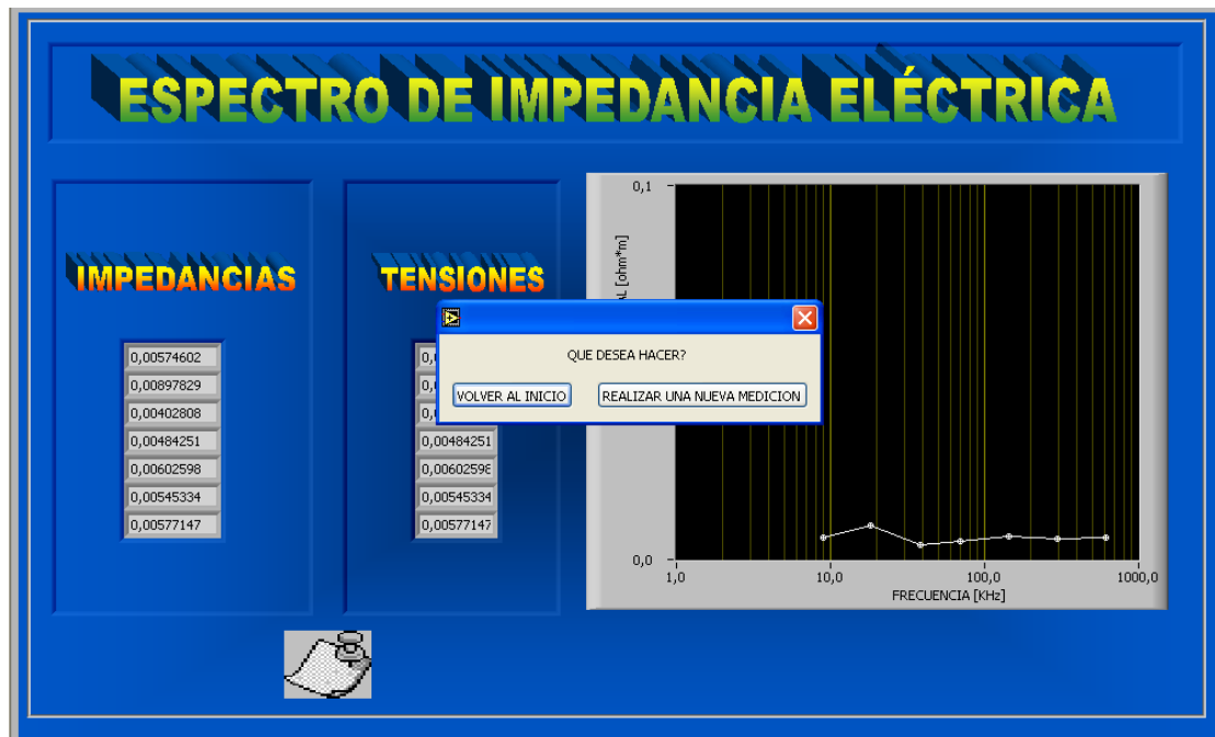
Figura 3.9. Panel de EIE y ventana para volver al inicio o realizar una nueva medición.
