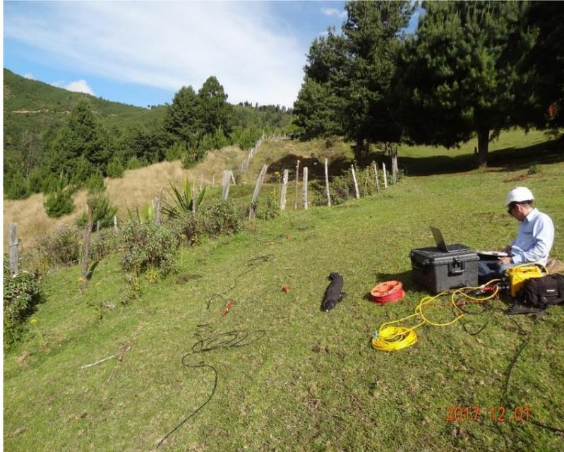
**Fotografía 19. Detalle centro de adquisición de datos de la Línea Sísmica LS1**
