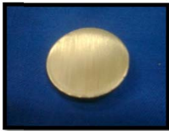
Figura 5. Probeta de trabajo para ensayos electroquímicos.
