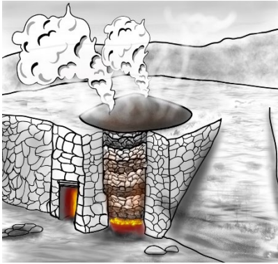
Figura 23. Calcinación de la piedra caliza
