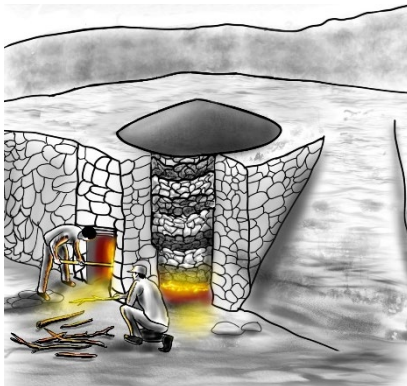
Figura 22. Ignición de la capa inferior del horno.
