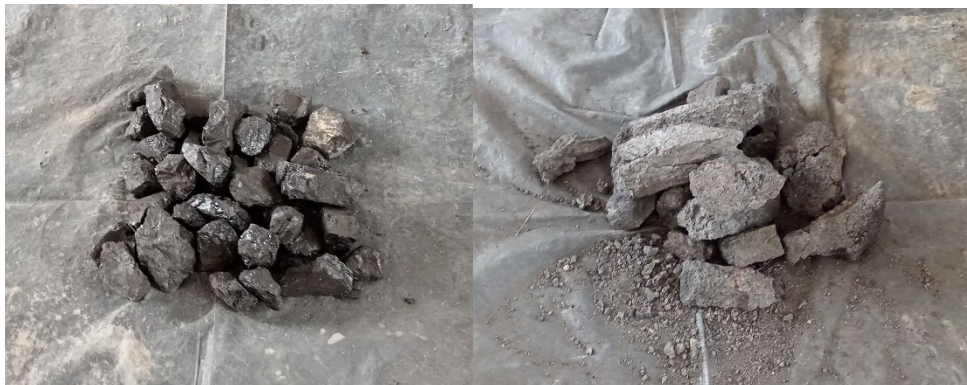
Figura 28. Mezcla de combustible compuesta de coque y carbón en una relación 10:1.
