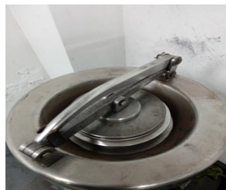
Figura 5. Molino de anillos utilizado para la molienda de los componentes.
