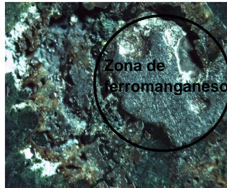
Figura 9. Muestra en baquelita mezcla 2 malla -80.
