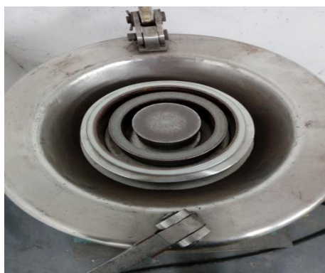
Figura 5. Molino de anillos utilizado para la molienda de los componentes.
