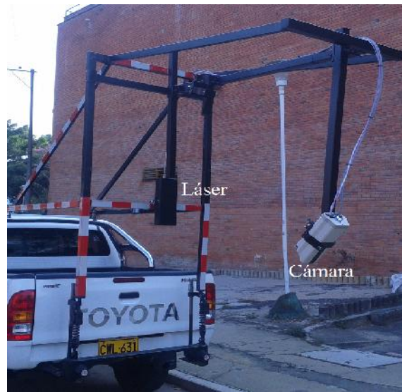
Figura 27. Montaje sistema primera y segunda fase
