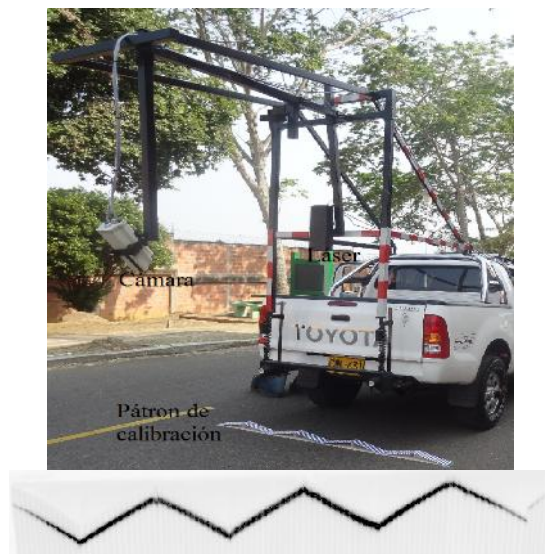
Figura 29. Patrón de calibración piramidal.
