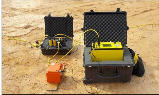
*Figura 60.* Equipo Supersting R8 fabricado por la empresa Advanced Geosciences, Inc., (AGI) con 56 electrodos, de propiedad del Grupo Geomática, Gestión y Optimización de Sistemas.
