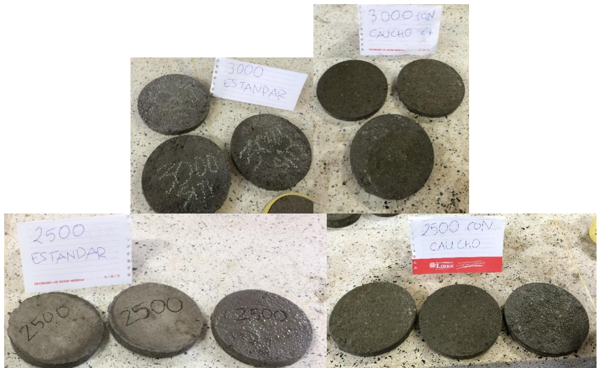
Figura No 27. Probetas para ensayo de Conductividad Térmica según su dosificación
