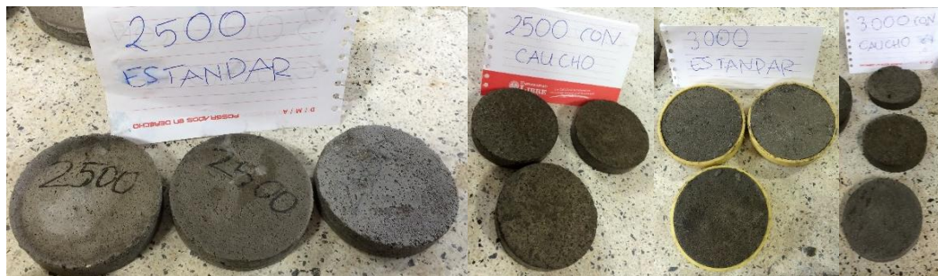
Figura No 14. Probetas para ensayo de Acústica según su dosificación
