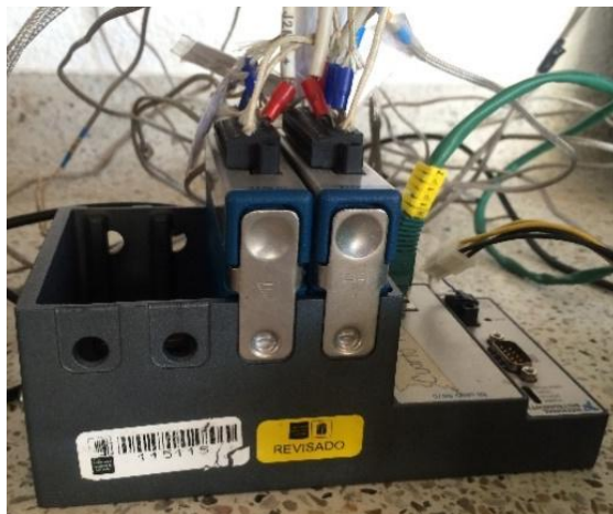
Figura No 23. Rio - Ensayo Conductividad Térmica
