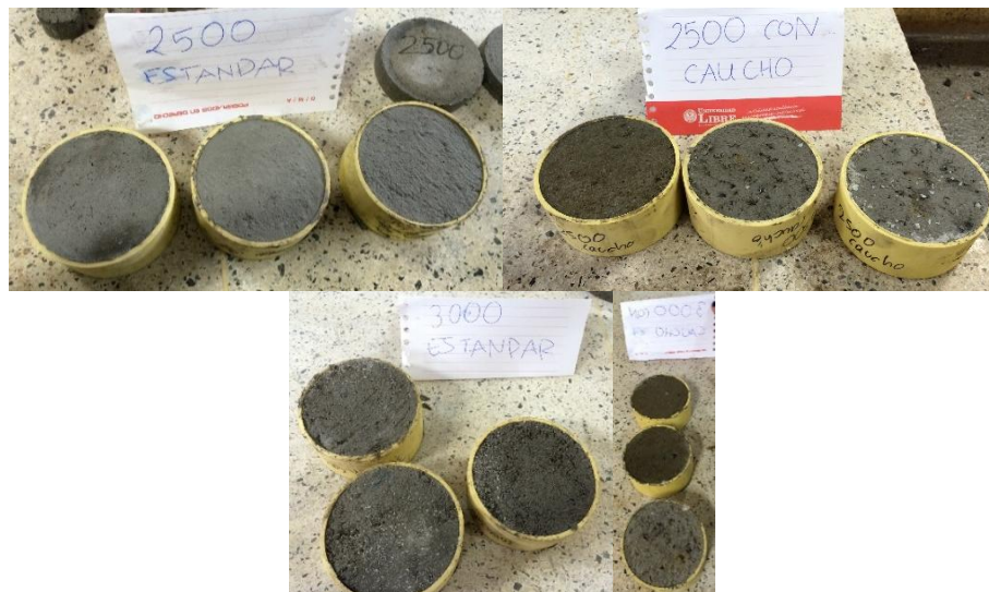
Figura No 20. Probetas para Ensayo de densidad porosidad y absorción - ASTM C642 según su dosificación
