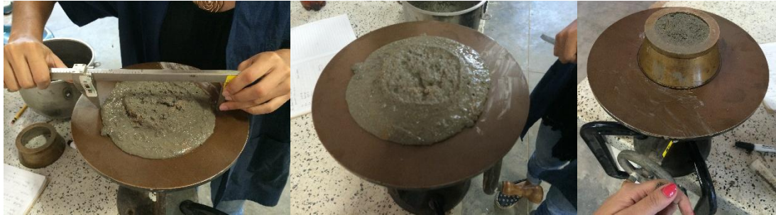
Figura No 7. Ensayo para determinar la fluidez de la pasta de mortero
