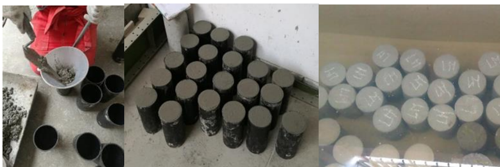
Figura 9 Proceso de fabricación de especímenes en el laboratorio
