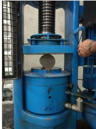
Figura 11 Ensayo de tracción indirecta de los especímenes
