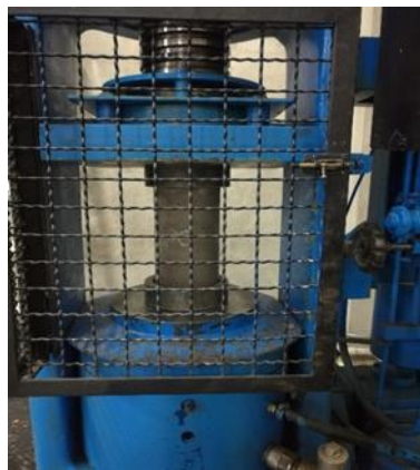
Figura 10 Ensayo de compresión simple para los especímenes
