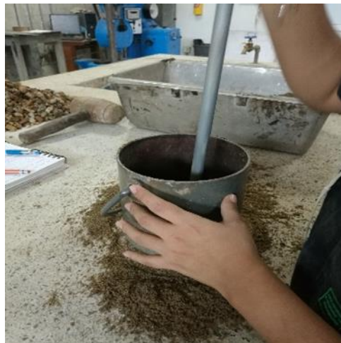
Figura 5 Ensayos de Caracterización en laboratorio (Prueba de gravedad específica)
