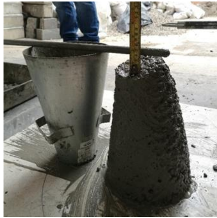
Figura 7 Prueba de Asentamiento logrado (4mm) punto (0,0)
