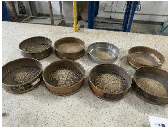
Figura 5 Ensayos de Caracterización en laboratorio (Prueba de gravedad específica)
