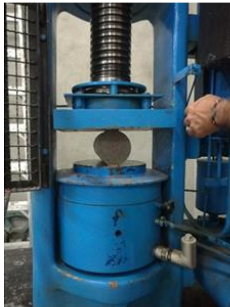
Figura 2 Ensayo de tracción directa
