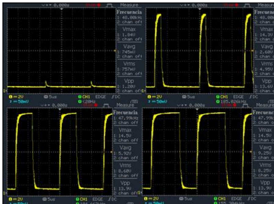
Figura 82. Variación del Duty para onda triangular. Fuente: Autores.
