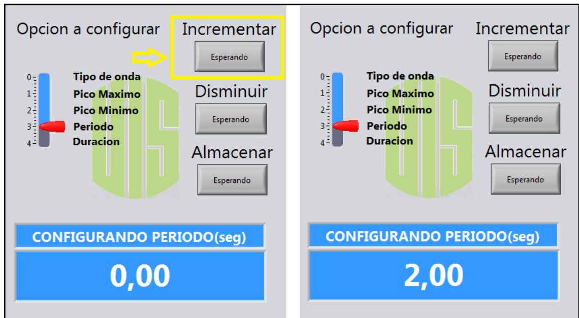
Figura 50. Panel Frontal. Ejecución del CASE 3. Periodo. Fuente: Autores
