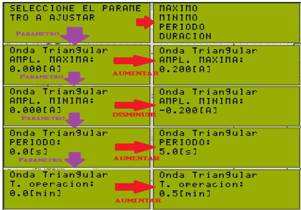
Figura 31. LCD, Configuración de parámetros. Fuente: Autores.
