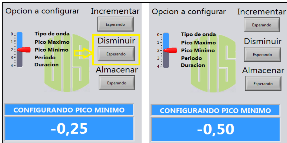
Figura 48. Panel Frontal. Ejecución del CASE 2. Pico mínimo. Fuente: Autores
