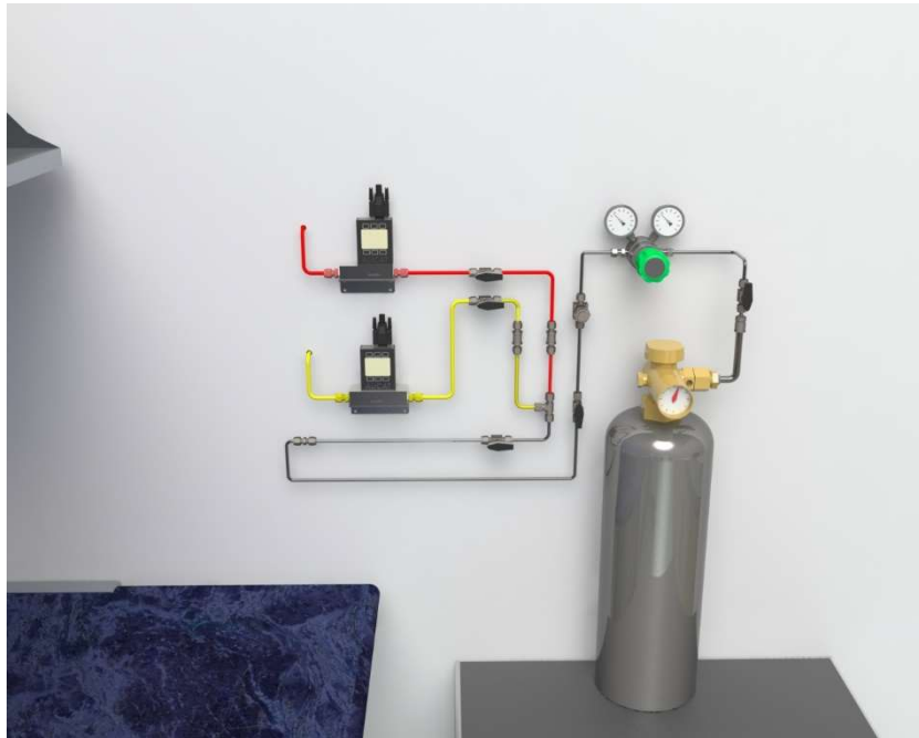
Figura 16. Instalación del sistema de dilución en laboratorio
