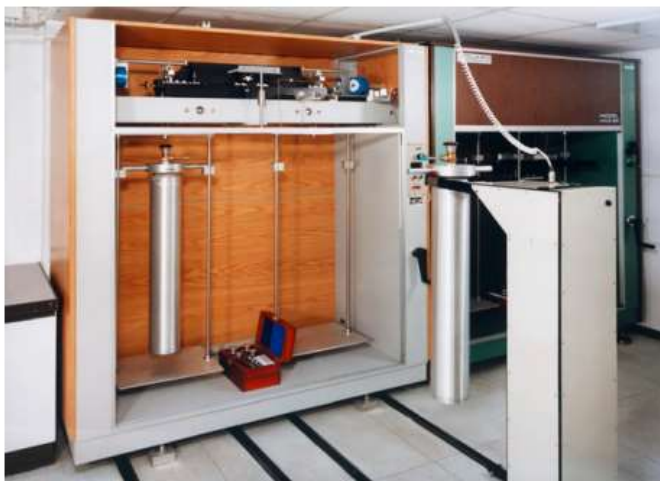
Figura 2. Balanza de dos platos utilizada en el Federal Institute for Material Testing (BAM) de Alemania
