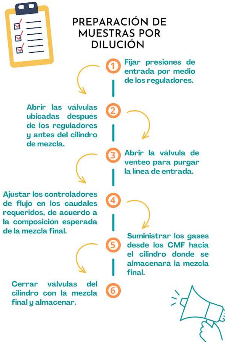
Figura 10. Procedimiento planteado para la preparación de mezclas por el método de dilución dinámica utilizando la técnica de CFM
