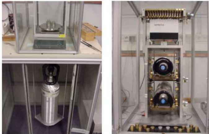
Figura 3. Balanzas de un solo plato del laboratorio Van Swinden Laboratory (VSL), de Países Bajos
