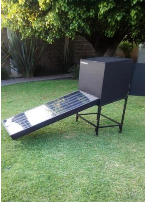
Ilustración 3. Colector solar por resistencia.
