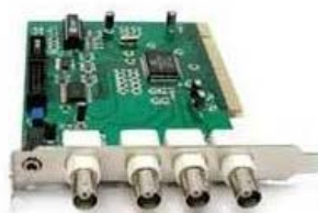
Figura 5. Tarjeta DVR PICO2000 para vigilancia en CCTV.
