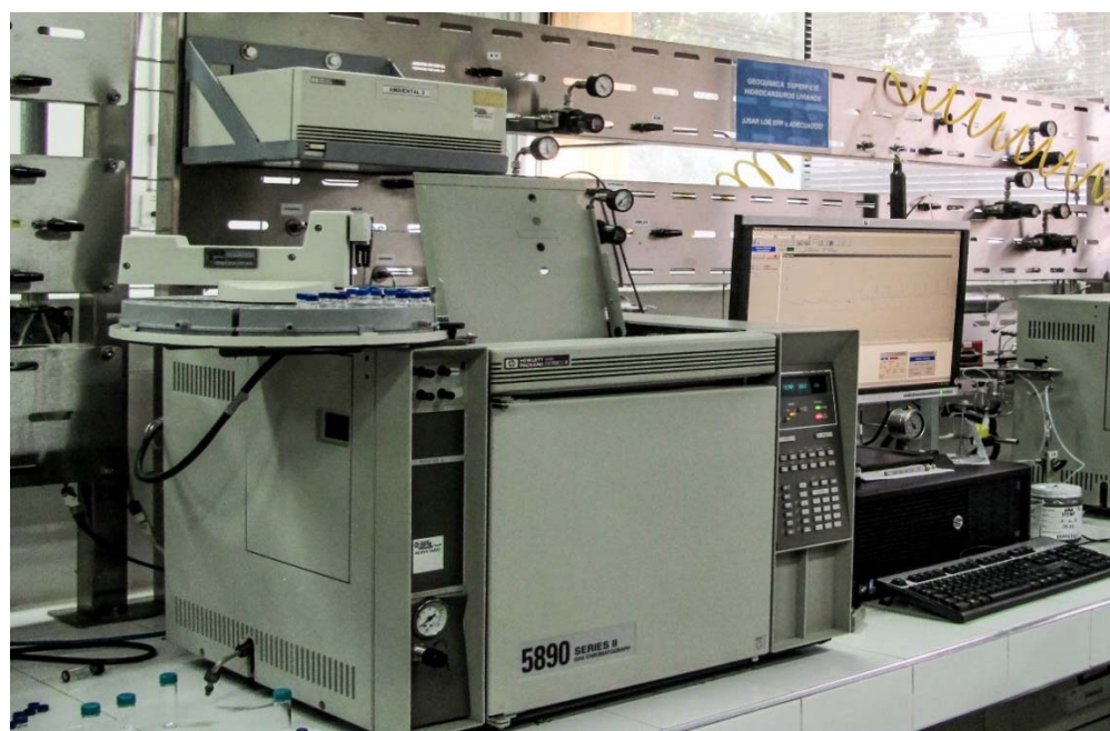
Figura 20. Cromatógrafo de gases con detector de ionización en llama. GC-FID/5890N Agilent Technologies Inc.
