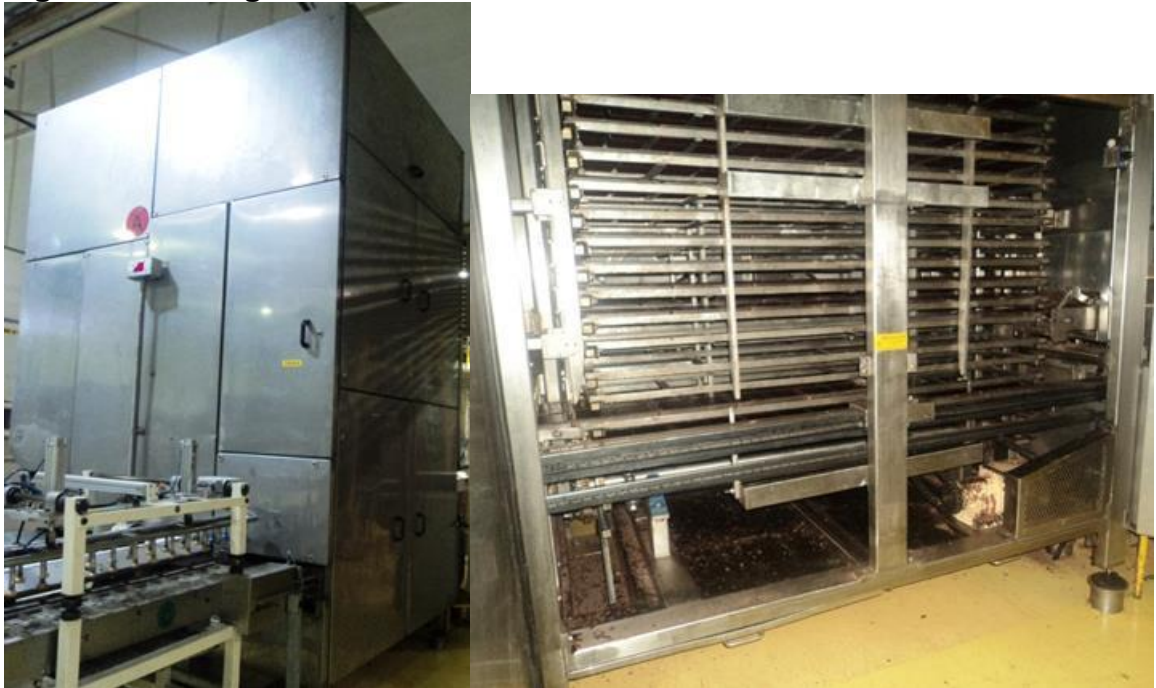
Figura 10. Fotografías Cava de Enfriamiento
