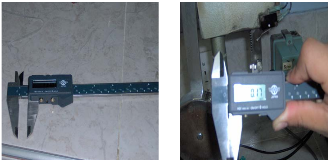
FIGURA 7. Instrumentos utilizados para medir el diámetro de la fibra de fique
