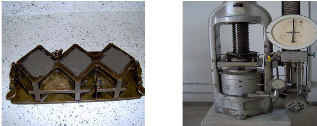
FIGURA 18. Detalles del ensayo a compresión del mortero
