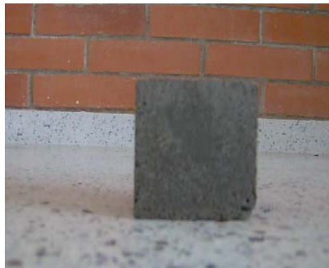
FIGURA 19. Probeta para el ensayo a compresión del mortero
