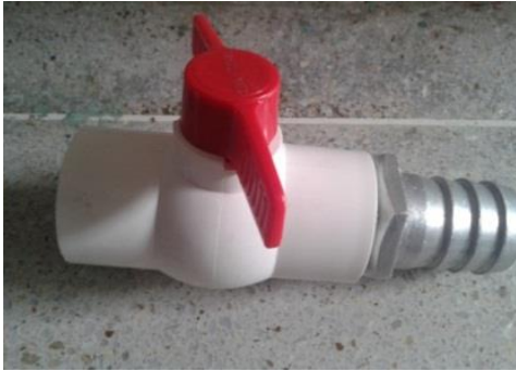
Figura 2-3. Válvula de cierre utilizada en pruebas hidráulicas.
