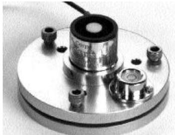
Figura B.2. Piranómetro MET ONE-Modelo 096. Tomado de [4].
