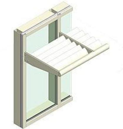
Figura 4.16. Parasol tipo horizontal<sup>10</sup>.
