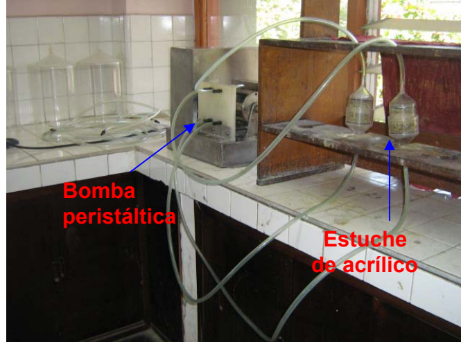
Figura 12. Montaje realizado para los ensayos de adsorción y desorción
