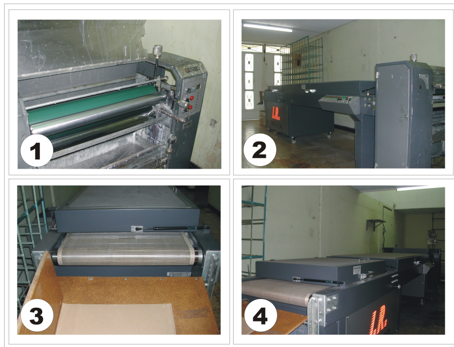
Figura 2.9: 1.Cabezote barnizador y controles electrónicos. 2.Perfil de la máquina, se aprecia el cabezote y el túnel de secado. 3.Bandeja de salida de cartón. 4.Detalle del túnel de aire helado
