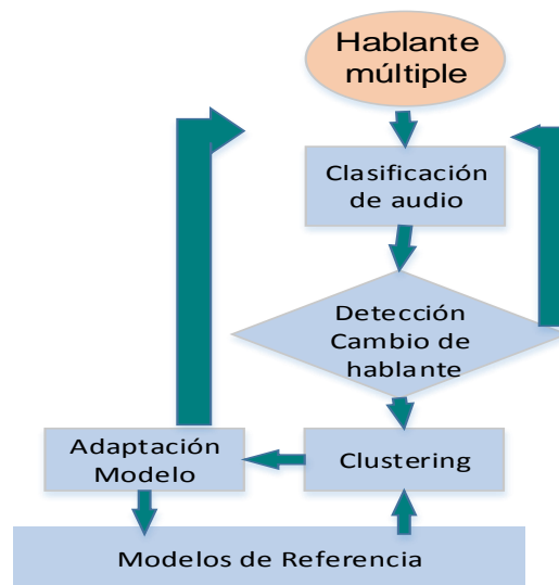
Figura 1. Método de segmentación de hablantes basado en detección de cambios. Adaptado de Kwon & Narayanan (2003).
