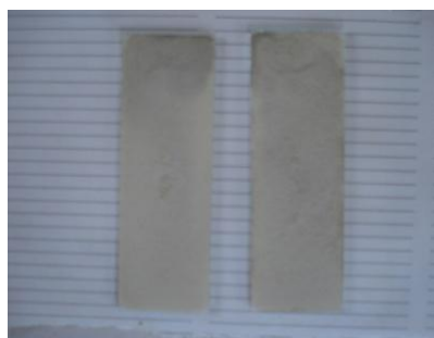
Láminas de arcilla natural y modificada, después de secado a temperatura ambiente
