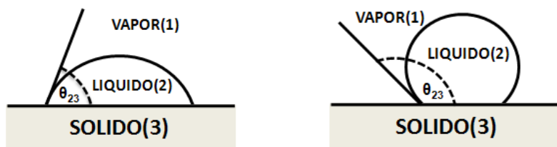
Figura 4. Representación de los diferentes casos de mojabilidad[15]
