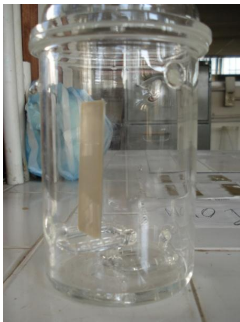
Lámina de bentonita natural depositada en la celda
