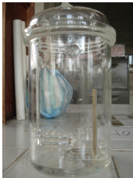
Lámina de bentonita natural en contacto con el solvente
