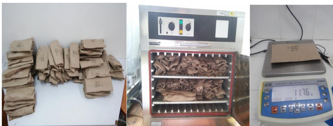
Apéndice 38. Secado en horno de las muestras, su respectivo pesaje después de 24 horas
