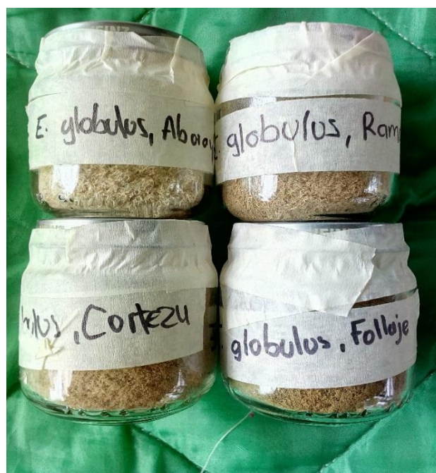
Apéndice 42 Muestras de Eucalyptus globulus pulverizadas para prueba de calorimetría
