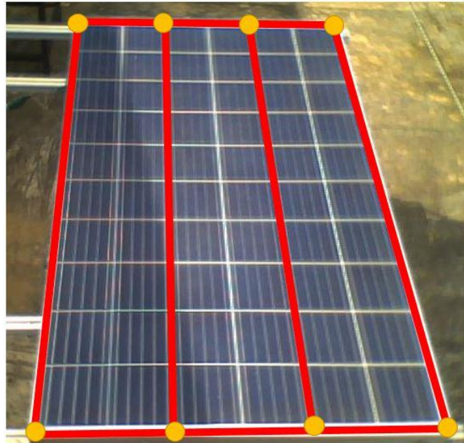
Figura 13. Módulos segmentados a partir de ecuaciones de recta.
