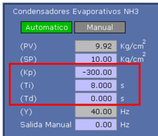
Figura 13. Parámetros visualizados por el InTouch del controlador PI.[Tomada de la interfaz gráfica de monitoreo Intouch 8.0 del área de refrigeración existente en la cervecería Bavaria de Bucaramanga]
