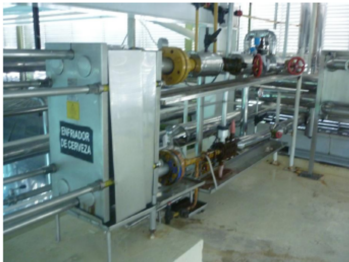
Enfriador de Cerveza filtrada. – Tabla de variables enfriador de Cerveza filtrada.
