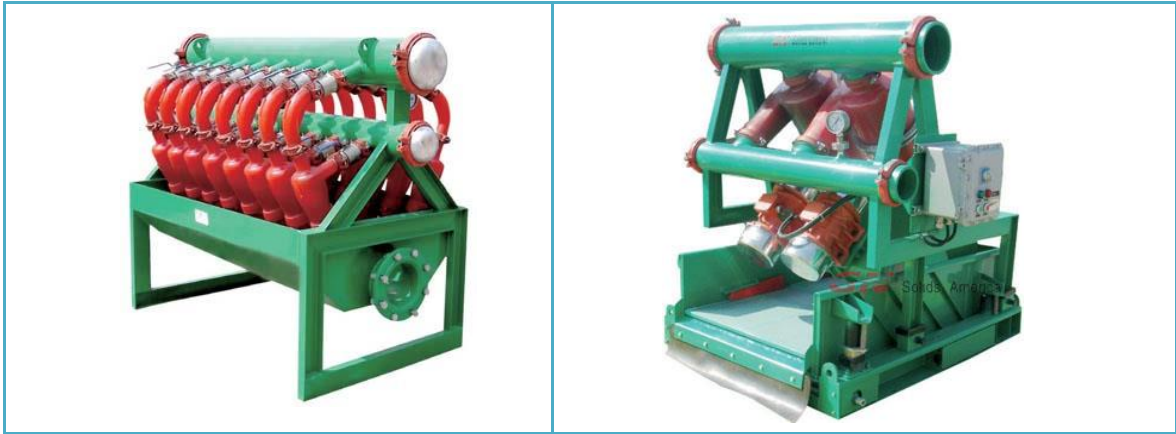
Figura 20. Desilter 39 y Desander 40
