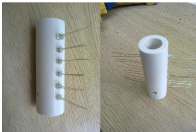
Figura 3.8. Fuente de radiación construida a partir de un arreglo de LEDs y acople de estos al portamuestras.
