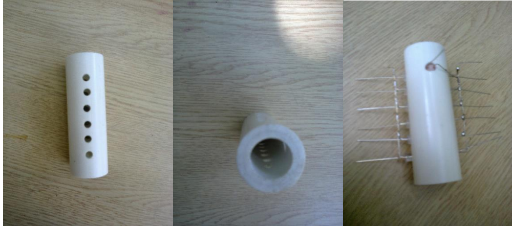
Figura 3.9. Portamuestras construido a partir de un cilindro hueco de PVC.
