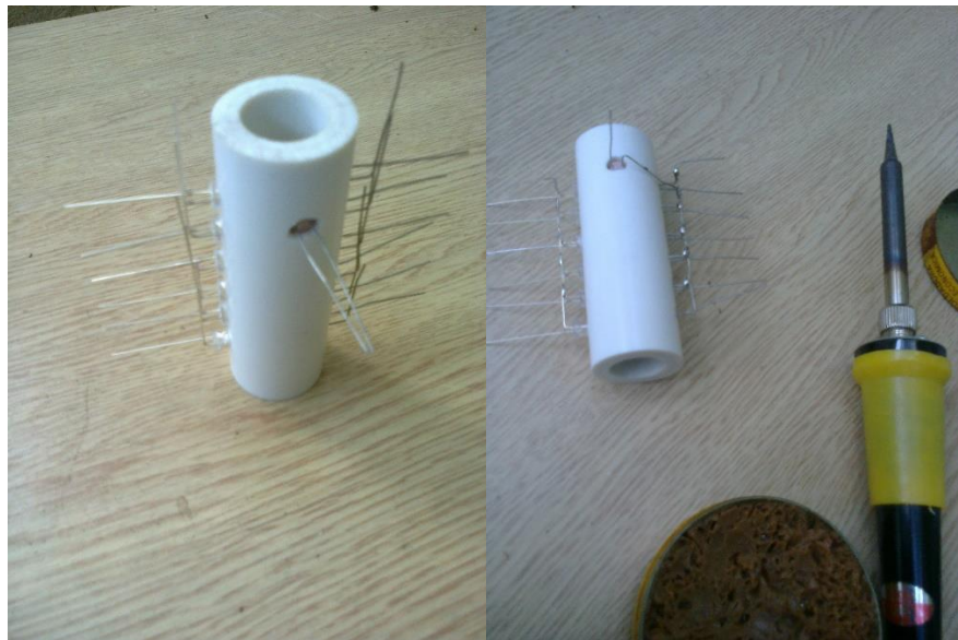
Figura A.3.7. Configuración de terminales y soldadura de estos según el diagrama electrónico de la Figura 3.16.
