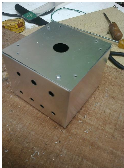
Figura A.3.3. Caja terminada lista para el ensamble de circuito electrónico y el sistema óptico.
