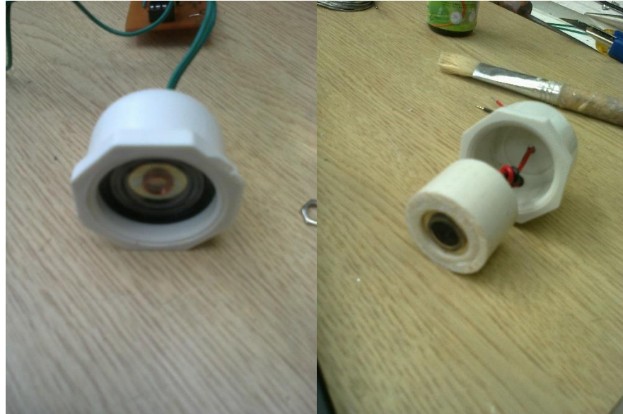
Figura A.3.8. Fabricación de la interfaz que acopla el circuito con la tarjeta de sonido de la PC, Construido a partir de dos tampones PVC, una fracción de tubo, el microcrofono, parlante y cable blindado.
