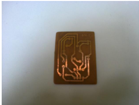
Figura A.3.10. Vista del circuito impreso luego del tratamiento con cloruro férrico.
