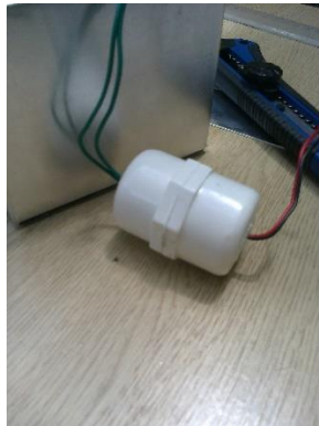
Figura 3.12. Interfaz blindada acústicamente mediante un cilindro PVC
