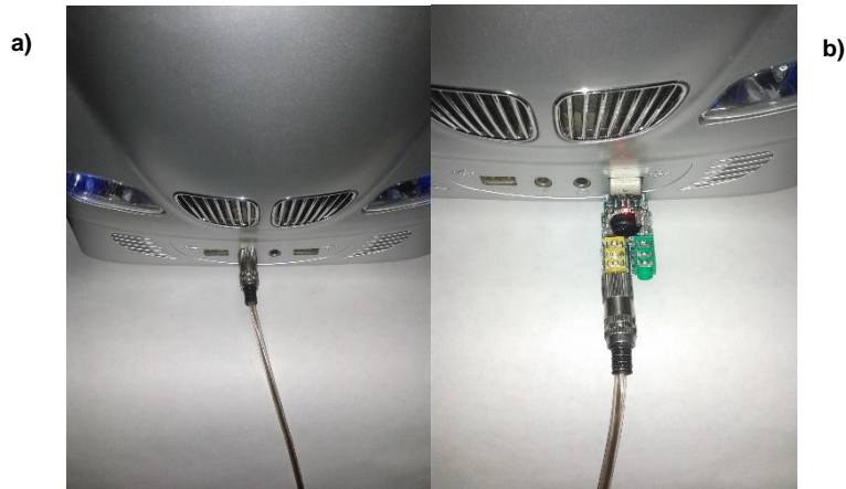
Figura 3.17. Tipos de conexiones permitidas por el equipo, a) mediante la tarjeta de sonido interna del computador y b) por medio de puerto USB.
