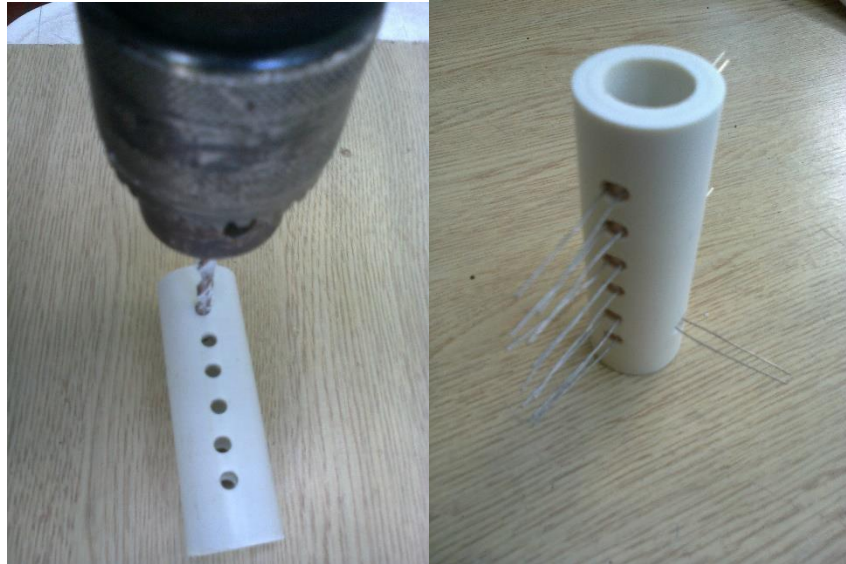
Figura A.3.6. Perforación de orificios y montaje de LEDs y LDRs dentro de los mismos.
