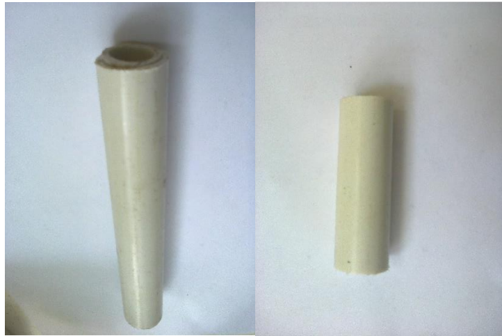
Figura A.3.4. Material de partida para la fabricación del portamuestras, constituido por dos tubos de PVC de 1/2 y 3/4". introducido uno dentro del otro.
