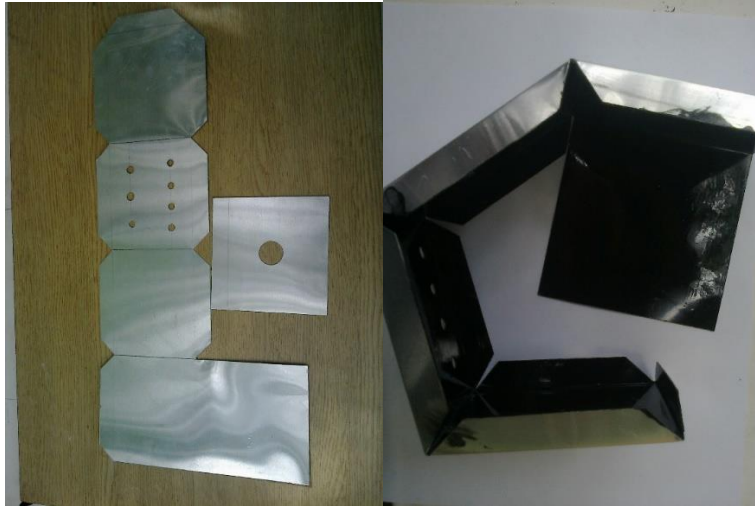
Figura A.3.2. Perforación de orificios, doblez de caras, pestañas y aplicación de pintura negra en la parte interna de la lámina.
